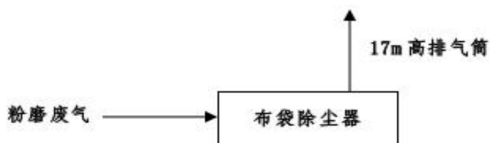
图 3.3 粉磨废气处理工艺流程图
