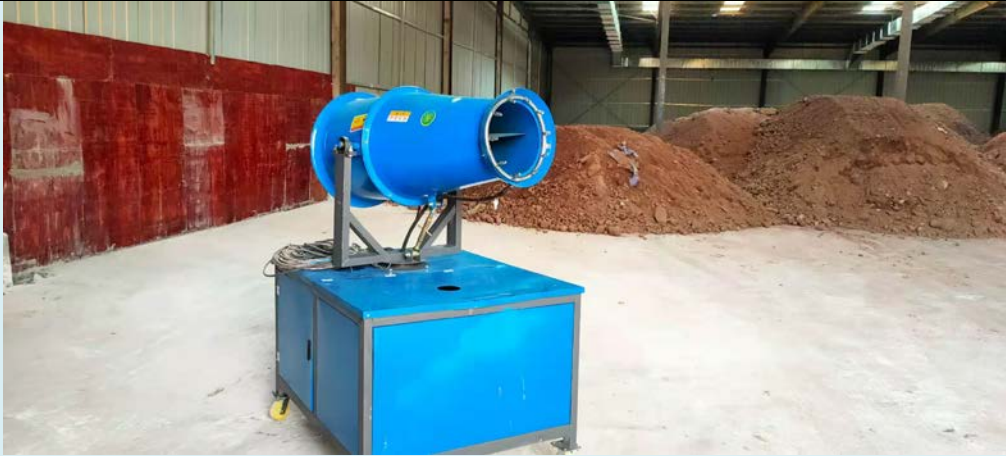
装卸过程中使用喷雾机喷雾降尘
